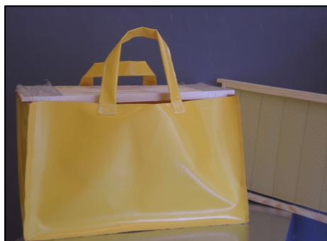
Container realizzato con materiale alta tenacità antistrappo e di poliestere spalmato in PVC, impermeabile, spessore mm. 0,50. Dimensioni: lungo cm 50, alto cm 30, largo cm. 30, capacità del contenuto in litri 45, di colore giallo, arancio e azzurro. Prove di resistenza effettuate sul Container con un contenuto di 115 kg. tenuto per i manici e sollevato per 180 minuti senza subire alterazioni.
